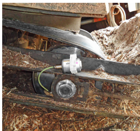
Y-lagerenheten på ett transportband tillförs fett kontinuerligt.
