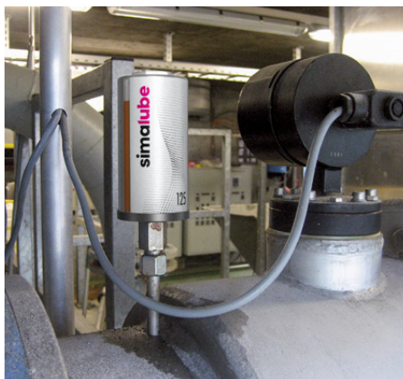
Smörjning av lager: smörjmedlet transporteras till lagren via en kort slang.
