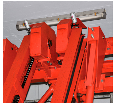
Kedjesmörjning med simalube på ett galler utrustat med borstar.
