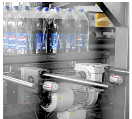
Lagret på en växel smörjs av två 60ml simalube.
