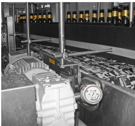
Smörjning av transportband med en simalubelubrikator.
