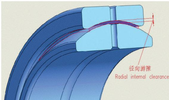
图 14 径向游隙
