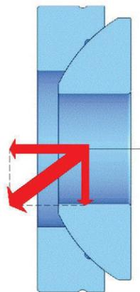
图12 推力关节轴承联合载荷
