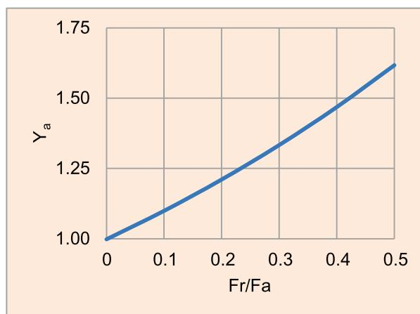
图表3 推力关节轴承的  $Y_a$  因子
