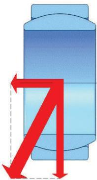
图10 向心关节轴承组合载荷
