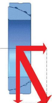
图11 角接触关节轴承联合载荷
