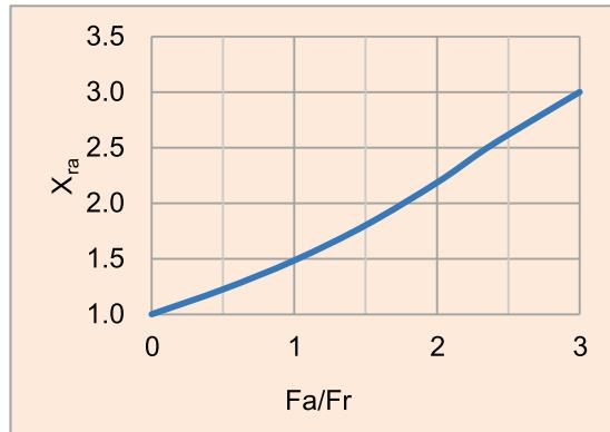
图表 2 角接触关节轴承 Xra 因子
