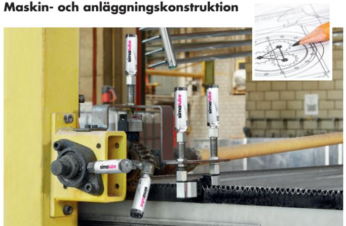
15ml simalube lubrikatorer försedda med borstar oljar kontinuerligt in kuggstängen på en lastmaskin. Andra 15 ml simalube lubrikatorer smörjer flänslagret med fett.
