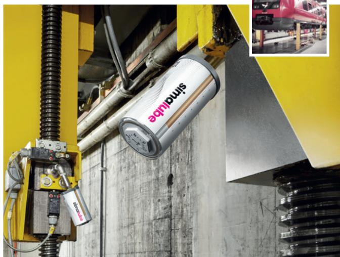
Spindlar på en lyftanordning för tåg smörjs med simalube 125 ml i 12 månader.
